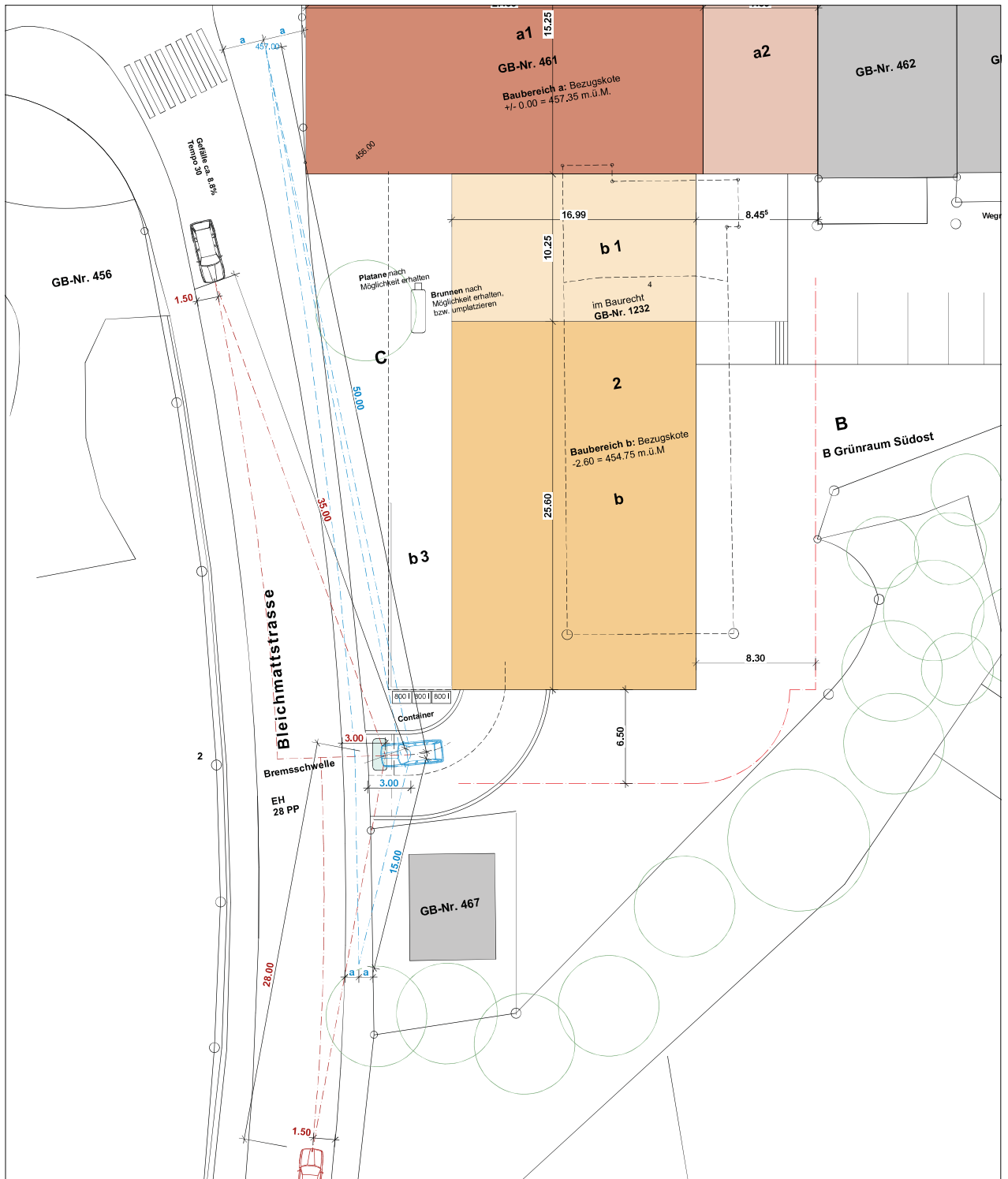
Sichtbermen bei der Ausfahrt der Einstellhalle auf die Bleichenmattstrasse
